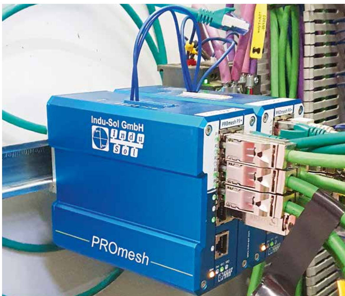
Die Switches der Promesh P-Serie erfassen die Zustandsdaten vom Netzwerk und machen die physische Qualität, d.h. den Verschleiß der Datenleitung, sichtbar.
